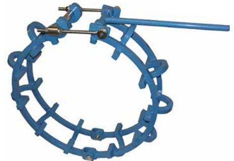
Die Mechanischen Käfigklemmen in leichter Ausführung sind für den Bereich DN 80 - DN 400 und nur für das Heften geeignet. Über den Exzenter werden beide Rohrenden mittels Stege gespannt.
