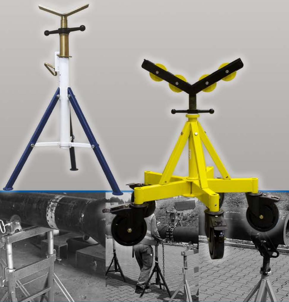
Alle Rohrstativ werden standardmäßig mit einem V-Kopf und Sicherheitsring geliefert, um ein unerwartetes Zusammenfallen und Verletzungen zu vermeiden. Die faltbare Version mit Tragegriff ermöglicht ein einfaches Abstellen und einen leichten Transport. Die Tragkraft des Rohrstativs beträgt 1.135 kg. Zudem sind die Köpfe austauschbar und unterschiedliche Rollensätze erhältlich.
