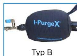
Das Formiergassystem besteht aus einer Basiseinheit und einer Eingangs- und Ausgangsdichtung mit jeweils zwei Lippen und ist geeignet für Rohrrinnendurchmesser von 25 mm bis 320 mm. Es kann einfach in das Rohr geschoben werden ohne das sich das System neigt oder biegt. Die Konstruktion stellt sicher, dass eine der jeweiligen Dichtlippen abdichtet und somit der Gasverbrauch und die Formierzeit reduziert wird.
