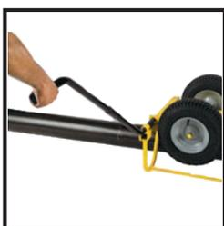
1 Rohr mit Ratschengurt an Cricket befestigen
