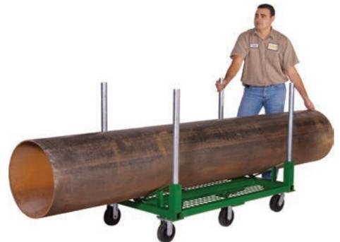
Transport eines 500mm Rohres
