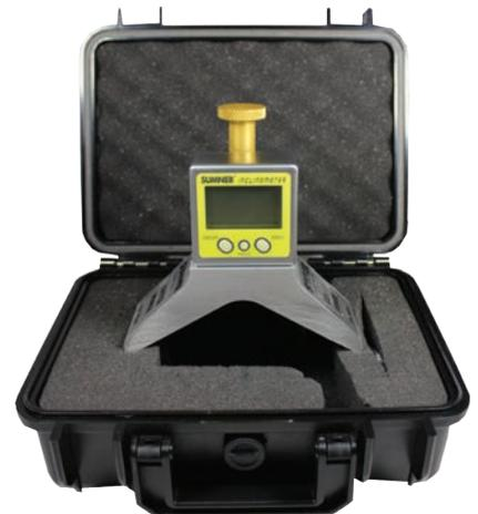
Die Flanschwasserwaage ist für Flansche mit Bolzendurchmesser von 16 mm bis 32 mm geeignet. Mit diesem Hilfsmittel werden Fehlpositionen von Teilen verhindert, dabei werden keine weiteren Einstellwerkzeuge benötigt. Der Bolzenabstand kann Stufenlos von 6 cm bis 26 cm variiert werden, sodass die Bolzenlöcher in waage gehalten werden.
