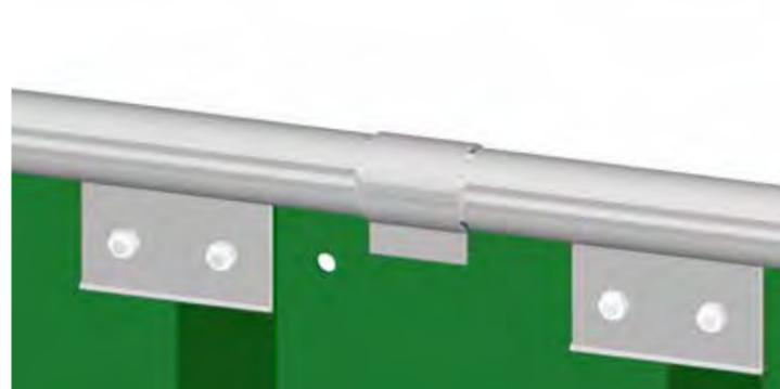
2 Drücken Sie die Pendelschale über das Rohr.
