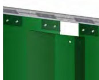
6 Bei einer Überlappung von 5 cm (33%) lassen Sie bitte jeweils 1 Loch frei und setzen Sie zur Ausfüllung ein Distanzstück ein.
